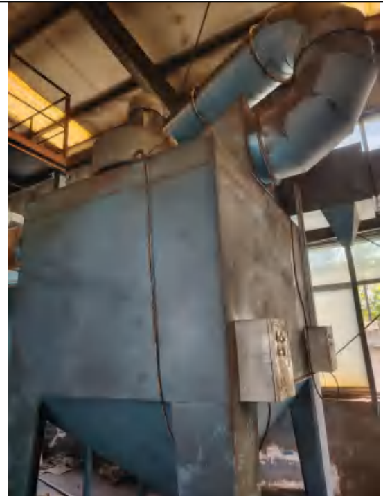
砂轮机布袋除尘器
