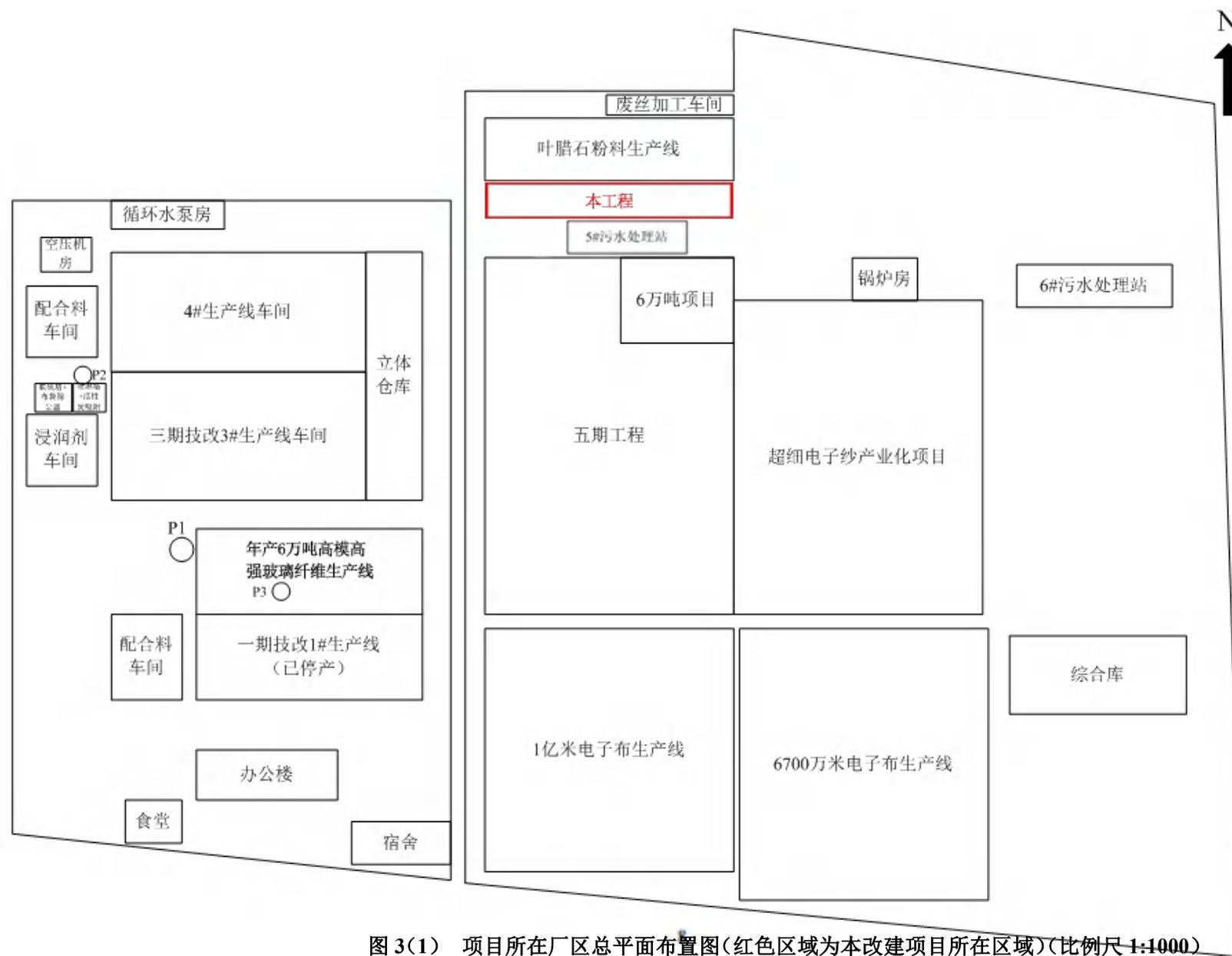
图 3(1) 项目所在厂区总平面布置图(红色区域为本改建项目所在区域)(比例尺 1:1000)
