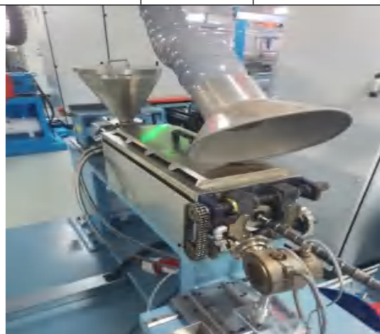
芯线押出生产线
