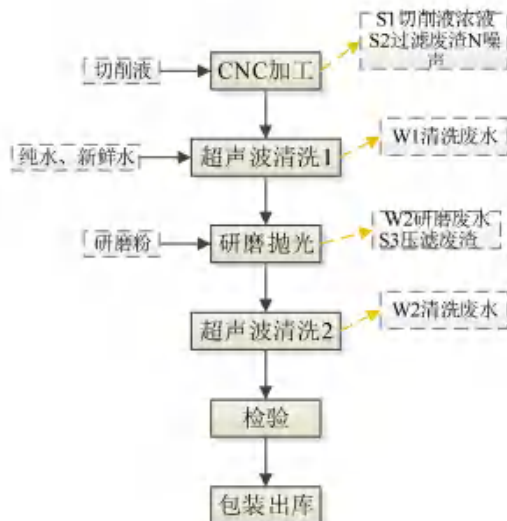
图 3-6 玻璃盖板工艺流程图
