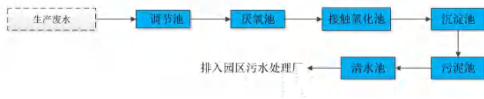
图 4-1 厂区污水处理站处理工艺流程图
