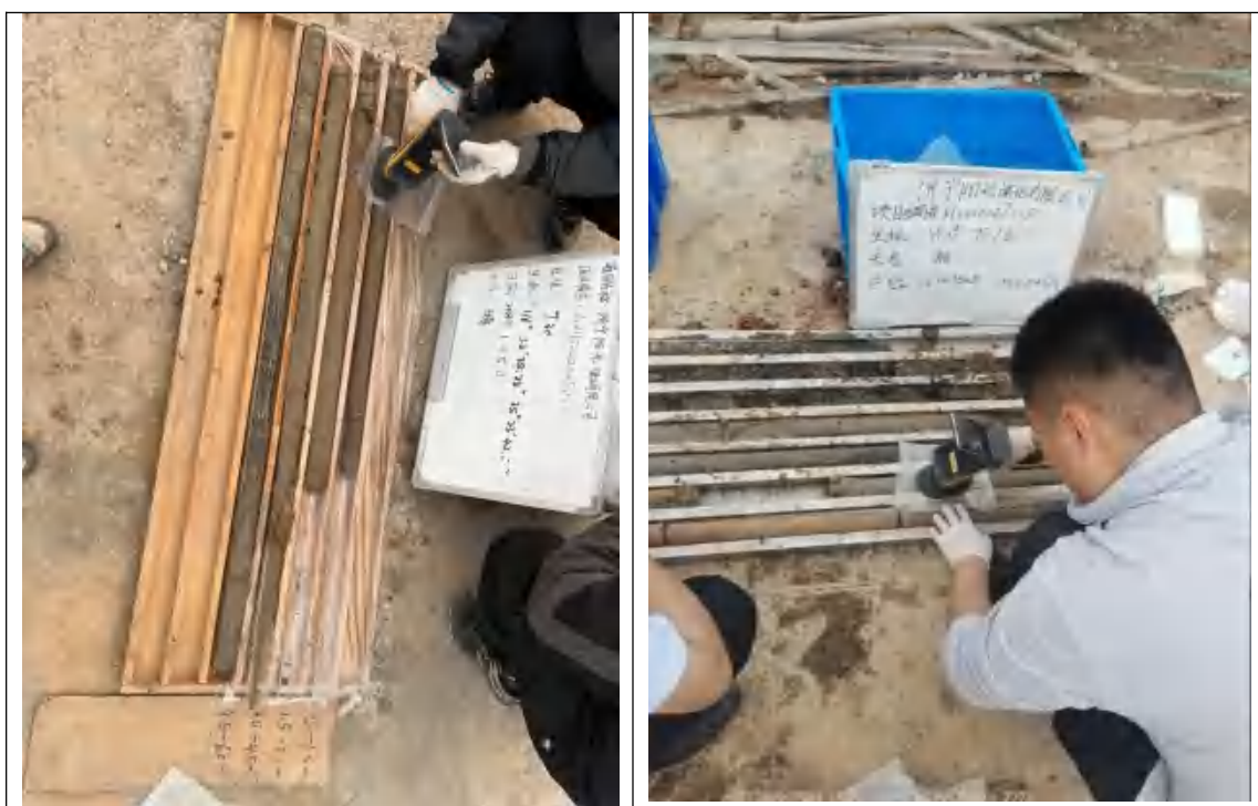
图 5.2-2 PID 现场检测土壤挥发性有机物
