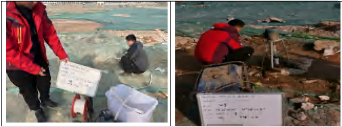
图5.2-8 洗井现场照片
