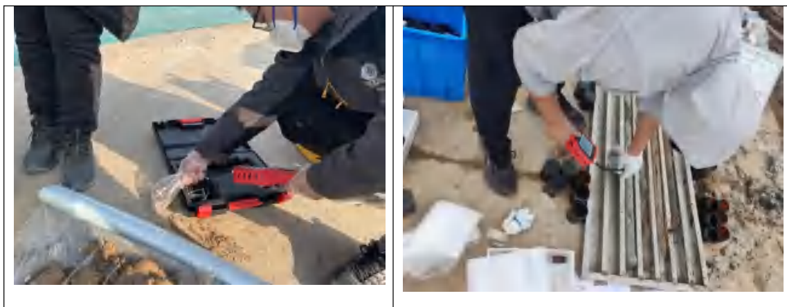
图5.2-1 XRF现场检测土壤重金属含量
