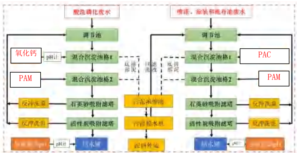
图 4-1 厂区污水处理工艺图
