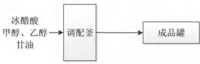
图 3-5 醋酸钠及复合醋酸钠脱氮系列助剂生产工艺流程示意图
