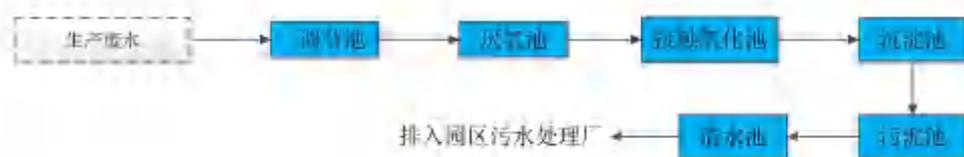
图 4-1 厂区污水处理站处理工艺流程图
