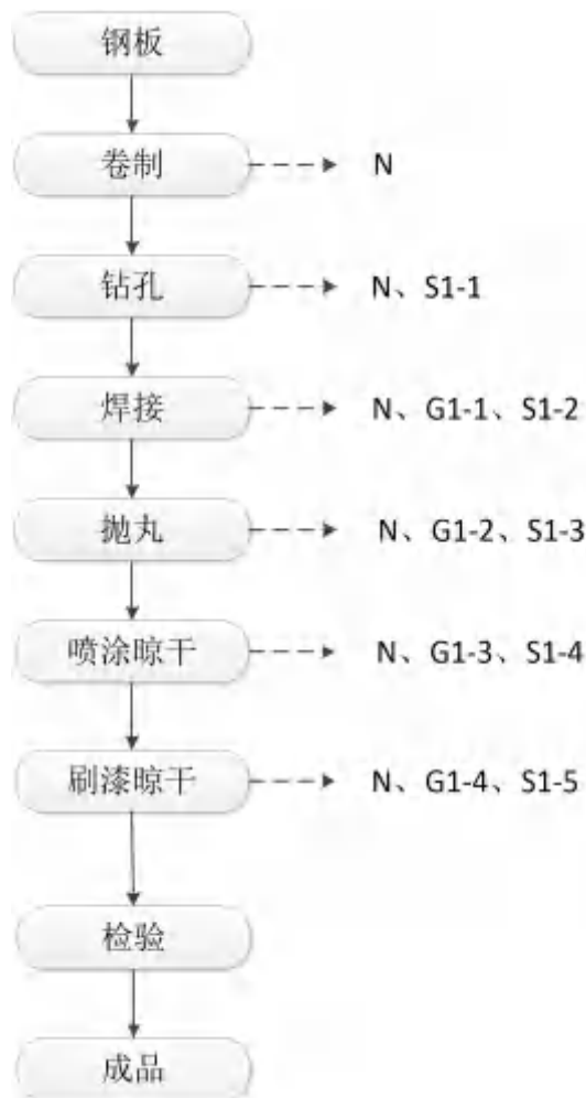
图 7 SF 双层罐生产工艺流程及产污环节图
