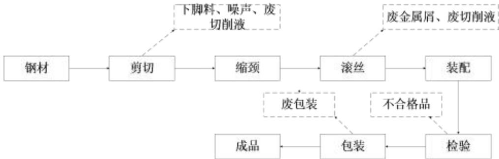
图6 工艺流程及产污环节图
